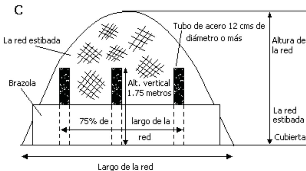
Si se están utilizando enjaretados de madera en cubierta, se deberá adicionar la altura que tengan éstos a la altura del soporte de red.
